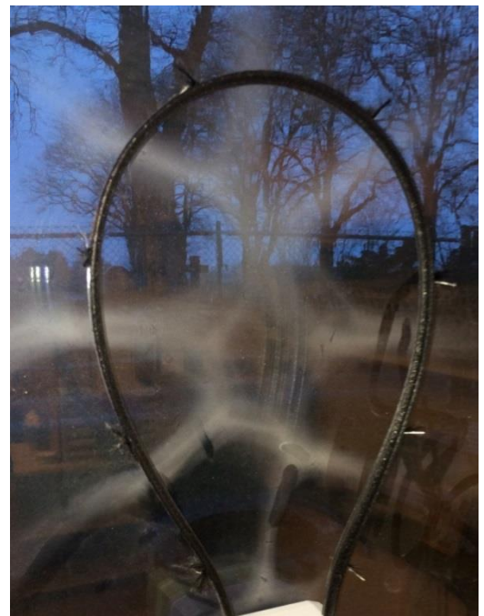
Fig. 1. En AirRevival applicerad i ett daghem. Notera hur partiklar fastnat på fönsterytan bakom emitterbågen.
